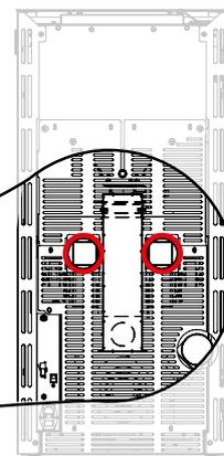
Genau hingeschaut: Die Warmluftausgänge führen die Wärme in den Luftkanal.
