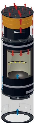
Das spezielle Wärmespeicher-System von Scan lässt bis zu 12 Stunden nach dem letzten Holznachlegen eine Wärmeabgabe zu.
