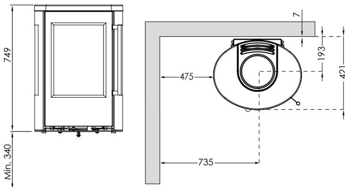
TT23RGW ist für die Montage an einer nicht brennbaren Wand vorgesehen. Wenn der Bodenbelag brennbar ist, muss der Kamin mindestens 340 mm über dem Boden angebracht werden. Sprechen Sie mit Ihrem Händler, um eine sichere und optimale Lösung für eine brandsichere Montage zu finden.
